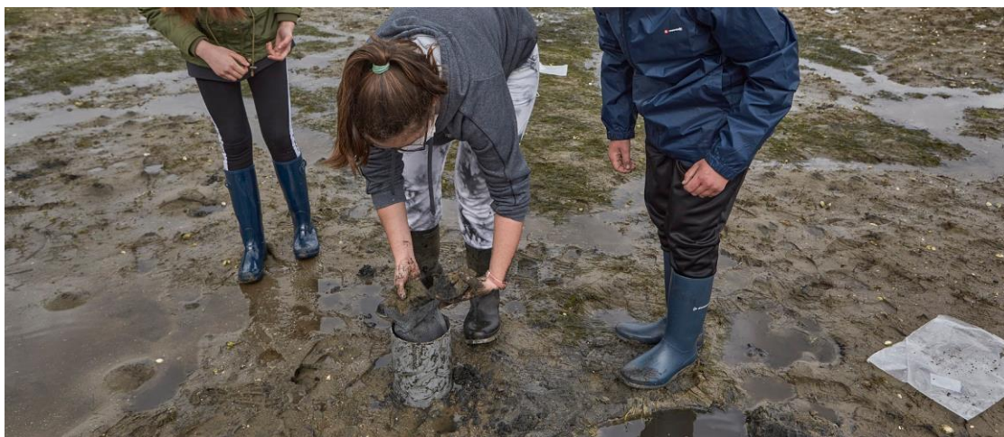
Prelevarea de probe cu un cilindru de sedimente
