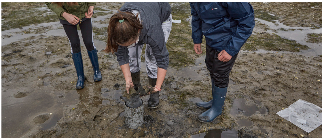
Amostragem com um cilindro de sedimentos
