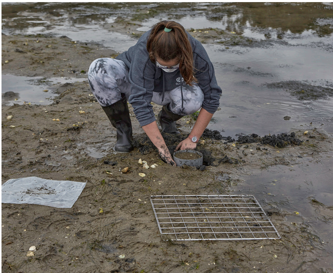
Técnica de amostragem para recolha de volumes de sedimentos para análise da relação entre Zostera e biodiversidade
